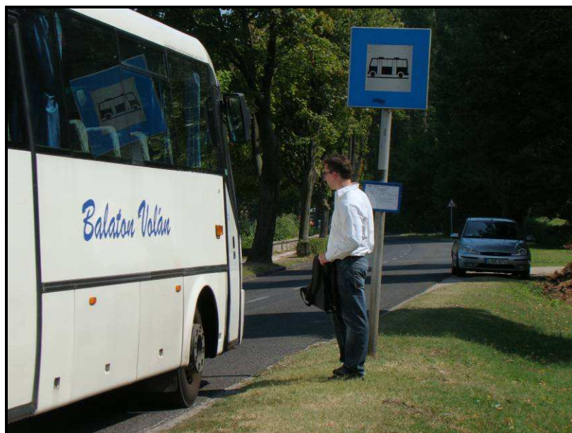
29. ábra: Elvben kisforgalmú megálló a kiemelt Balatonfüred-Tihany vonalon. Sem öböl, sem peron, sem esőbeálló nem található, a menetrendszerinti autóbusz az útpadkán –szabályosan - várakozó utast veszi fel. (Fotó: Ekés András)
