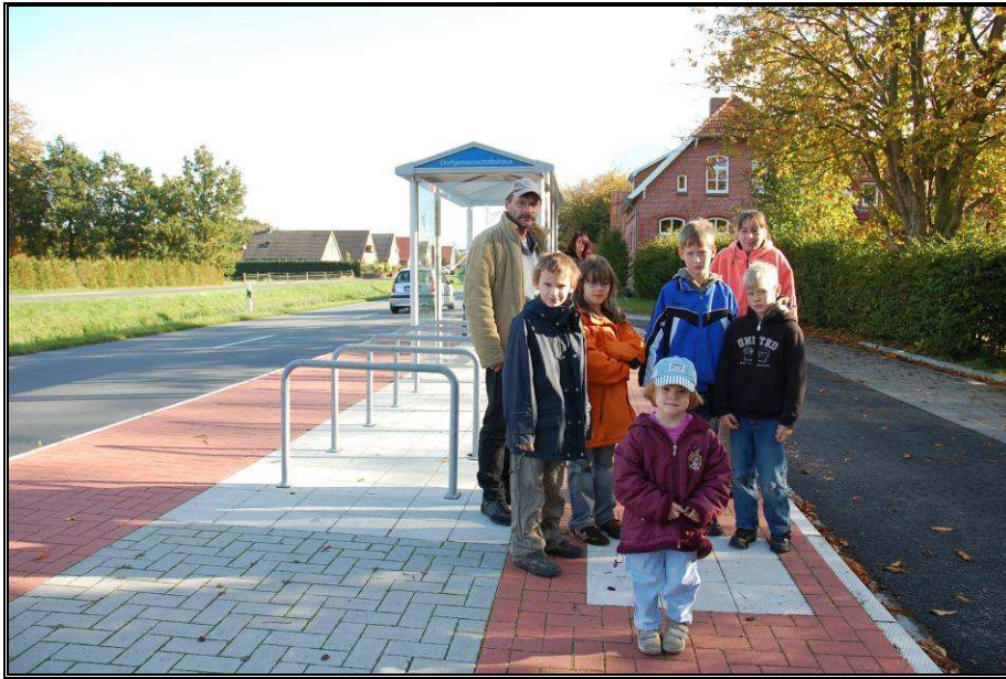
31. ábra: Akadálymentes peron buszmegállóban kerékpártámaszokkal és esőbeállóval (Wiesmoor).
